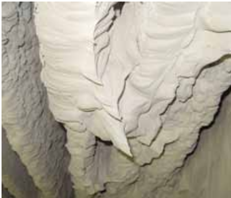
Verschmutzungen im Dampfkessel
